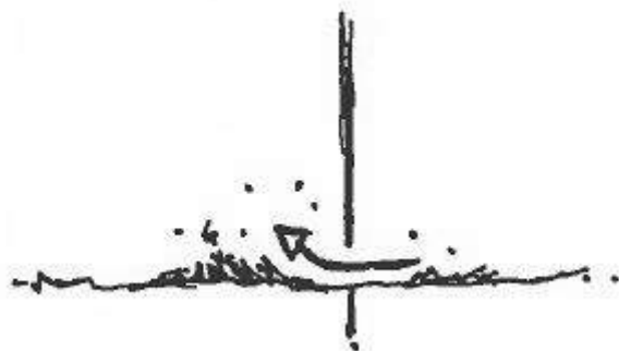
Principe de perméabilité de la clôture pour le passage de la petite faune
