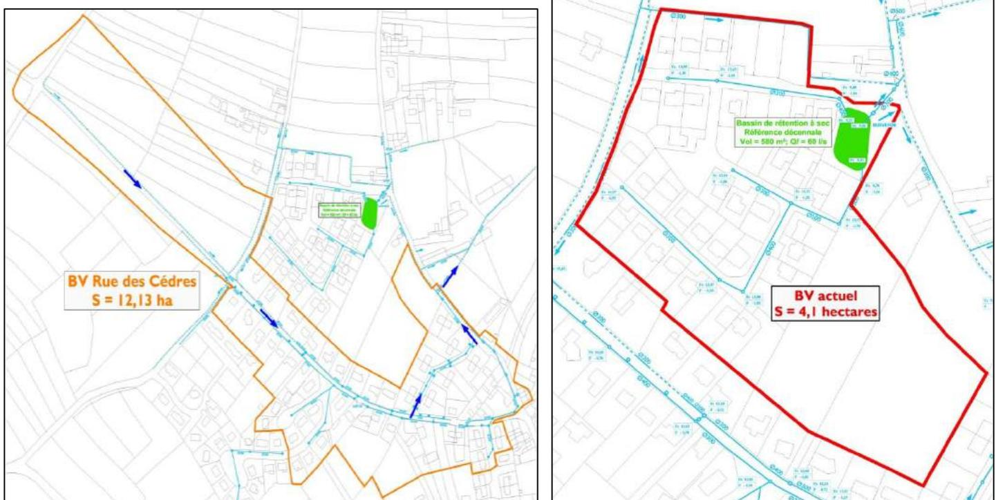
Illustration 14 : Limite du bassin versant « Rue des Cèdres » de l'étude hydraulique de 2013 et limite du bassin versant raccordé au bassin d'orage
